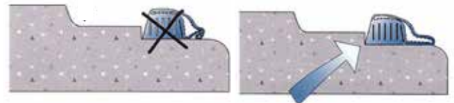
Her vil pakningen ikke rulle korrekt. Risiko for muffesprængning. Korrekt placering af pakning.
